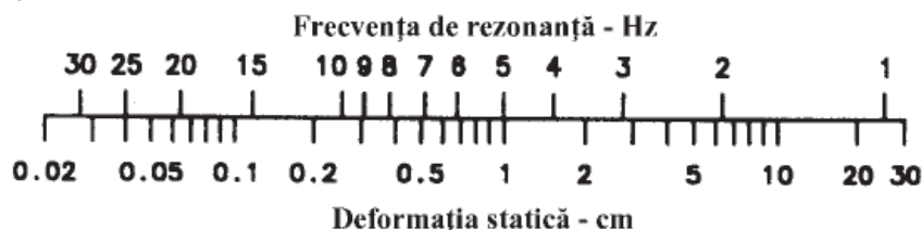
Fig. 4.6.2 Relația dintre deformația statică \delta și frecvența de rezonanță f_n
